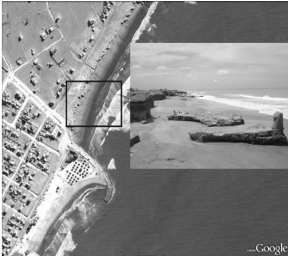
Figura 7: Sector de la costa de Mar de Cobo, se puede observar como al norte de la escollera aumentan las condiciones erosivas, provocando el rápido retroceso de los acantilados labrados sobre sedimentos loessicos.
