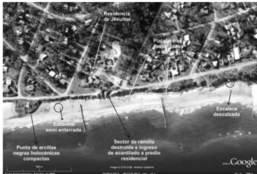
Figura 8: Vista Google de Setiembre de 2006 de los últimos tres espigones en Las Vegas y la afectación en rambla y "Casa de los Curas". Se indica la localización de las escaleras de acceso ya no funcionales. Observese el retiro en más de 10 metros del borde del acantilado a espigones.
