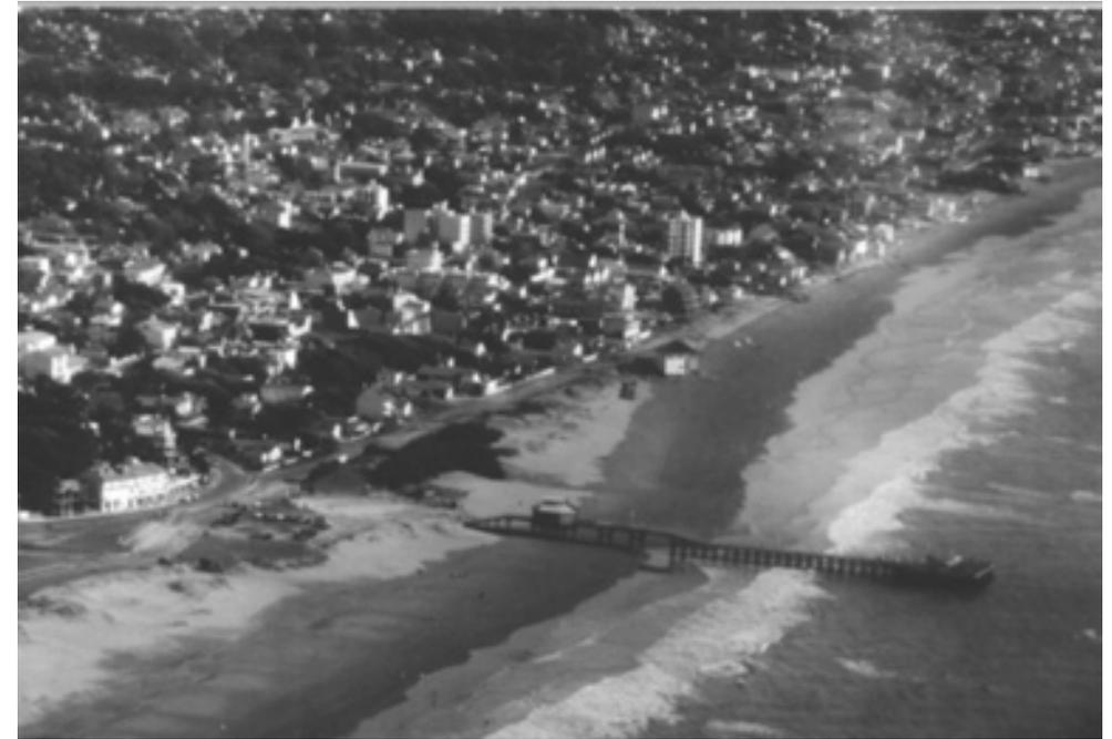
Figura 5: Condiciones acrecivas (norte) y erosivas (sur) provocadas por el muelle de Mar del Tuyú
