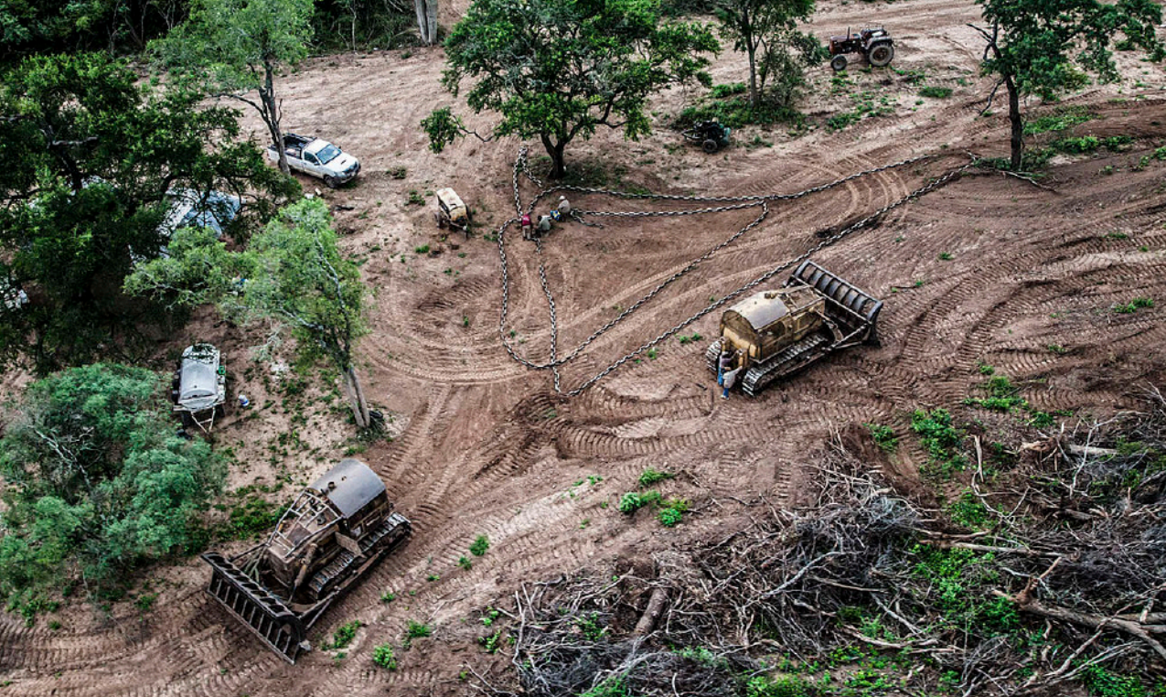
Topadoras con grandes cadenas preparadas para continuar con el desmonte en el chaco salteño. Foto: Greenpeace
