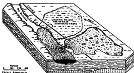
Fig. 49.4. Maqueta que muestra las características principales de un deslizamiento en arcilla muy limosa, cerca de St. Thiribe, Canadá. (Según C. F. S. Sharpe.)
