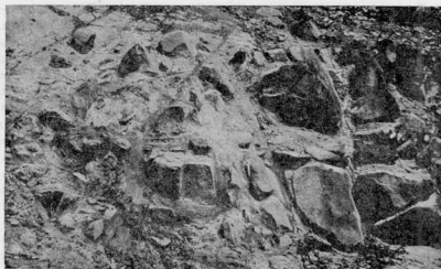
Fig. 2.2 Bloques producidos por la meteorización a lo largo de las juntas.
