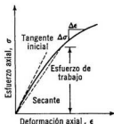
b. Curva de esfuerzo deformación con módulos de elasticidad tangente y secante como pendientes de la tangente inicial y de la secante, respectivamente.
