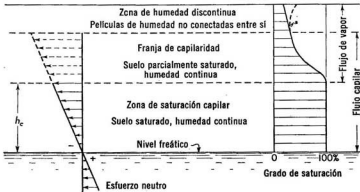
Fig. 4.13 Equilibrio capilar y distribución de la humedad en el suelo.
