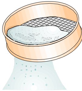
Figura IV.37(a): Tamiz para granulometrías.
