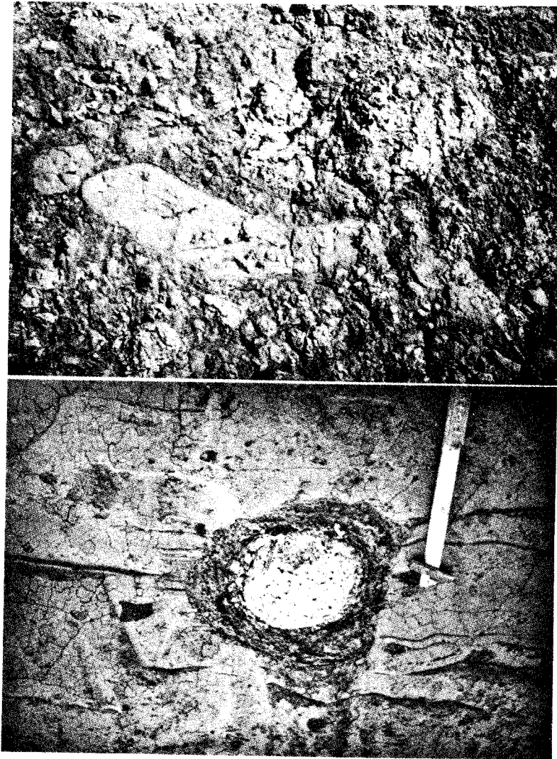
Figura 6.36. Alforamientos de suelo residual mostrando los efectos de la meteorización esferoidal.
