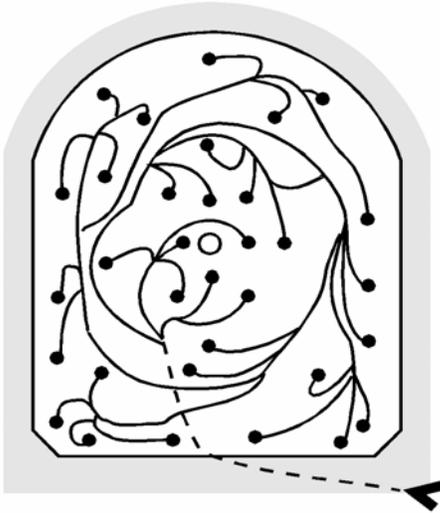
Arranque por corte quemado con hueco central sin carga
