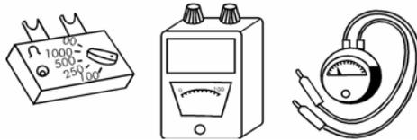
Ohmnímetro, Voltímetro y Galvanómetro para la comprobación de circuitos de disparo
